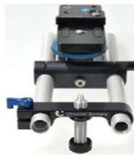
401-33 (auf LWS 401-421S) Objektivstütze mit umgedrehter Stellschraube. Durch den 5mm Zapfen der Schraube kann der Stativanschluß von Teleobjektiven genutzt werden, um das Objektiv zu stützen.
